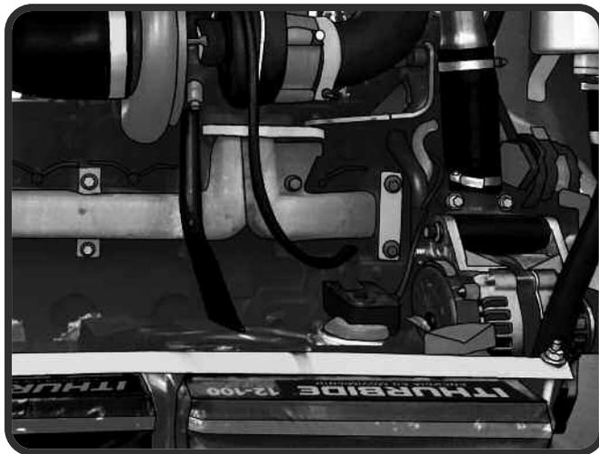
**/ Cada 2000 Hs. de Trabajo:** Haga desarmar, controlar, limpiar, lubricar el alternador y el motor de arranque. Es aconsejable controlar el correcto funcionamiento del regulador de carga.
